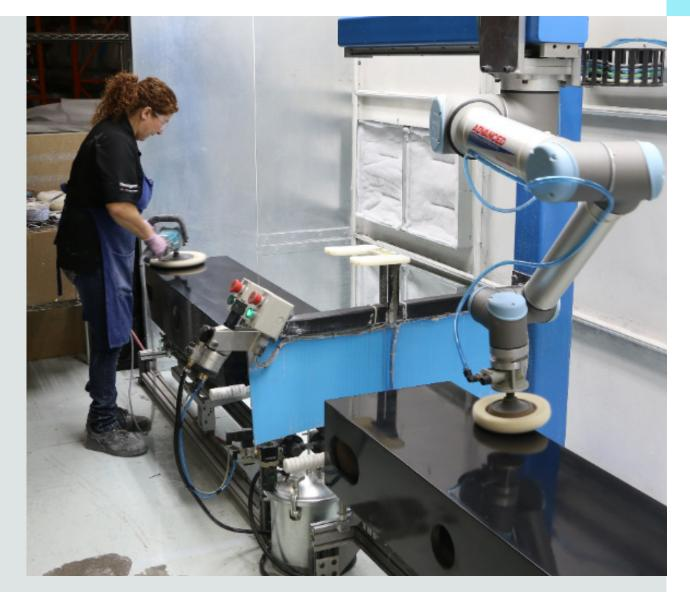
新しいロボットを導入したことで過酷な作業が減ったことに非常に満足しています。ロボットの設置は素早く簡単に行うことができました。協働ロボットは安全柵がなくても動作できるように設計されているので、スペースが広くなり喜んでいます。
